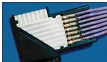
Figura 19: Soldagem em conjunto de fios elétricos para cabos de fita (FFC). Soldagens simultâneas são possíveis porque não há nenhuma passagem de corrente elétrica pela área da solda. O processo é insensível a variações de condutividade de arame para arame.
