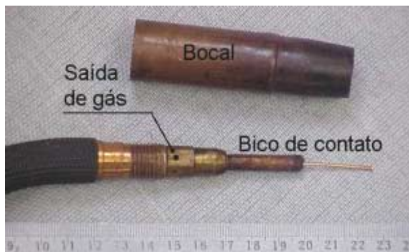
Figura 4 – Tocha para a soldagem GMAW semi-automática.
