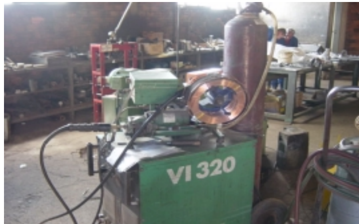
Fig. 03 Equipamento de soldagem MIG manual.
